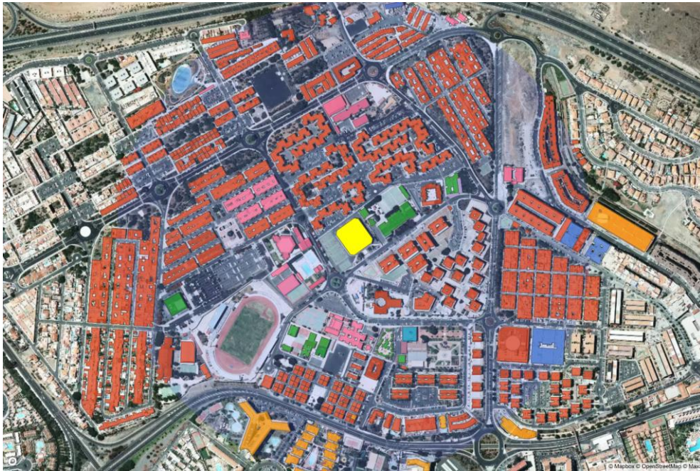
F3. Mapa del área de 500 metros de radio alrededor de la instalación fotovoltaica planteada en el edificio municipal. Las edificaciones marcadas en colores según su uso, podrían entrar a formar parte de la CEC.
